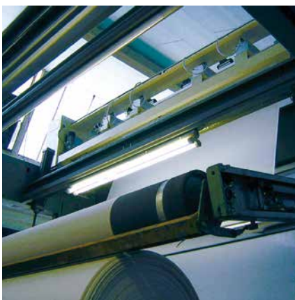
ELSTRAIGHT Mini am Auslauf einer Spanmaschine
