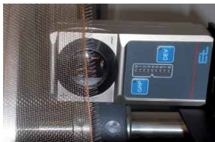
Infrarot-Kantensensor FR 52 für Gittergewebeerfassung
