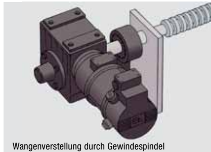
Wangenverstellung durch Gewindespindel
